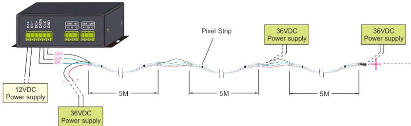
5.2 DMX wiring diagram.
