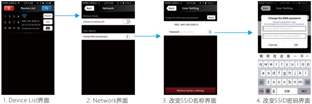
**【注】**如果是WiFi-104作为路由器直连方式，修改SSID名称和密码后，请退出软件，进入移动设备系统设置重新连接WiFi-104。
